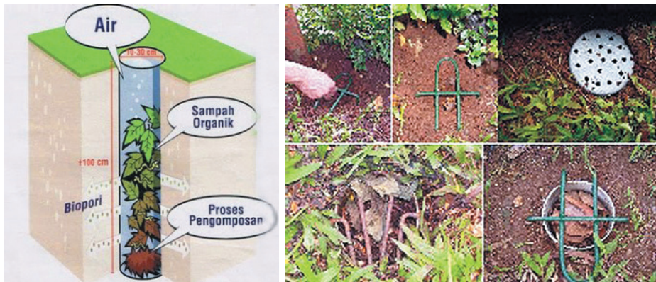
Gambar 10.19 Teknologi Biopori untuk Penampungan Air Hujan serta Pemanfaatannya untuk Pembuatan Kompos
