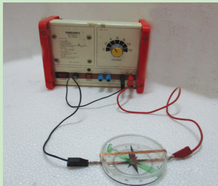
Gambar 6.25 Percobaan Medan Magnet di Sekitar Kawat Berarus
