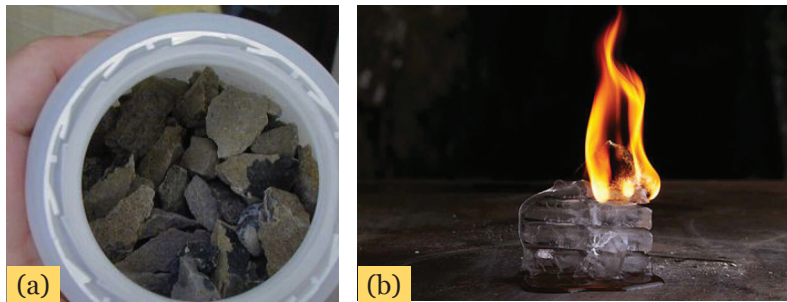
Gambar 8.38 (a) Karbid, (b) Reaksi Karbid dengan Air
